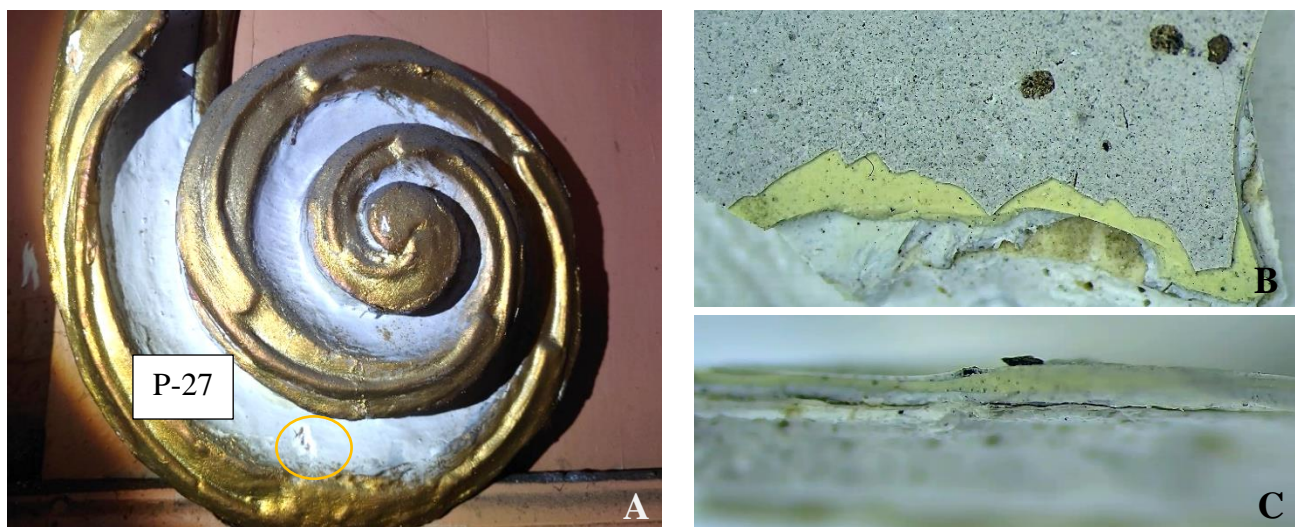
28 pav. Mėginys P-27: A – mėginio paėmimo vieta, B – mėginio vaizdinė pusė pro mikroskopą, x80; C – mėginio skerspjūvio vaizdas pro mikroskopą, x100
