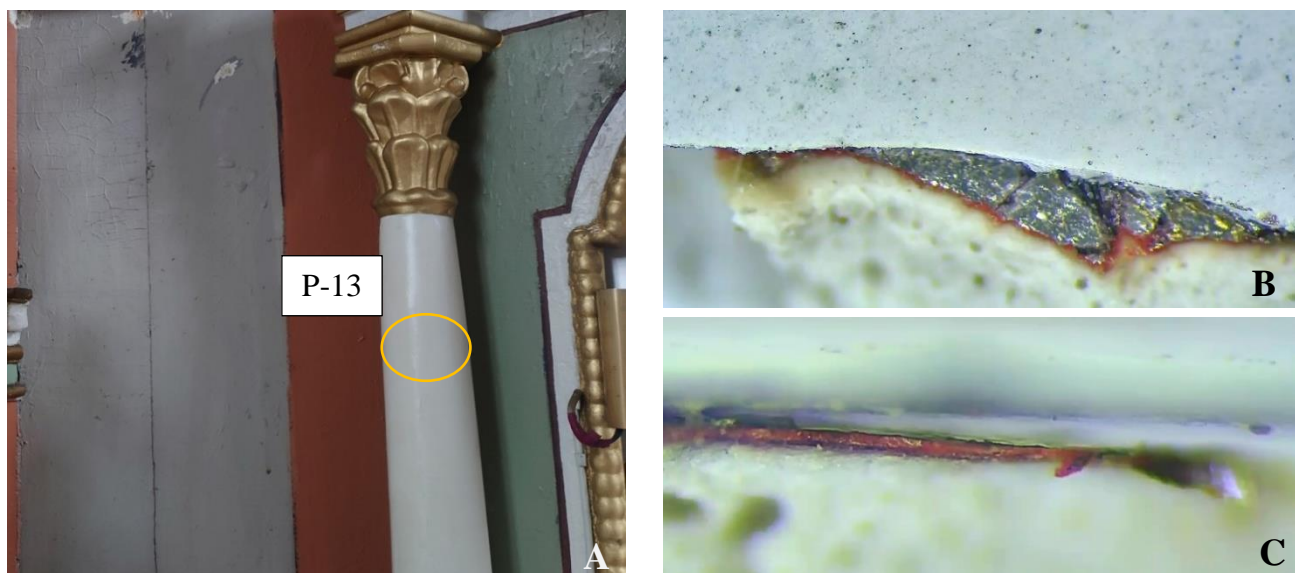
14 pav. Mėginys P-13: A – mėginio paėmimo vieta, B – mėginio vaizdinė pusė pro mikroskopą, x80; C – mėginio skerspjūvio vaizdas pro mikroskopą, x100
