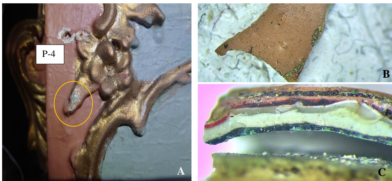
5 pav. Mėginys P-4: A – mėginio paėmimo vieta, B – mėginio vaizdas pro mikroskopą, x80, C – mėginio skerspjūvio vaizdas pro mikroskopą, x100;
