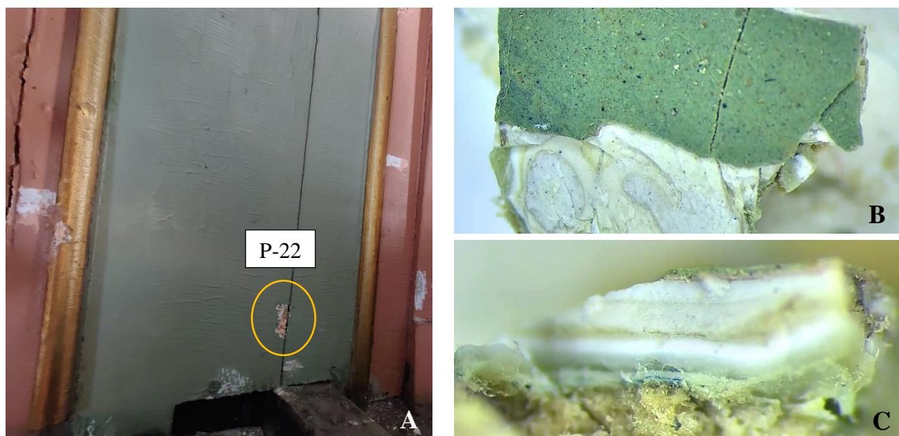
23 pav. Mėginys P-22: A – mėginio paėmimo vieta, B – mėginio vaizdinė pusė pro mikroskopą, x80; C – mėginio skerspjūvio vaizdas pro mikroskopą, x100
