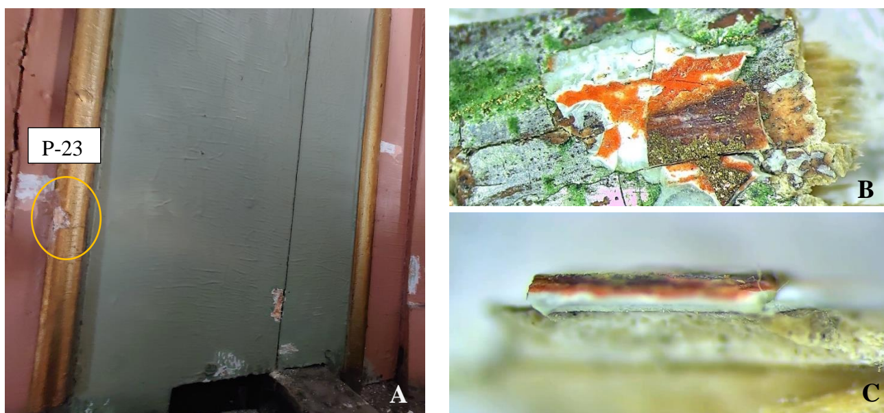
24 pav. Mėginys P-23: A – mėginio paėmimo vieta, B – mėginio vaizdinė pusė pro mikroskopą, x80; C – mėginio skerspjūvio vaizdas pro mikroskopą, x100
