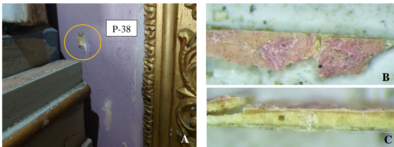
41 pav. Mėginys P-38: A – mėginio paėmimo vieta; B – mėginio vaizdinė pusė pro mikroskopą, x80; C – mėginio skerspjūvio vaizdas pro mikroskopą, x100
