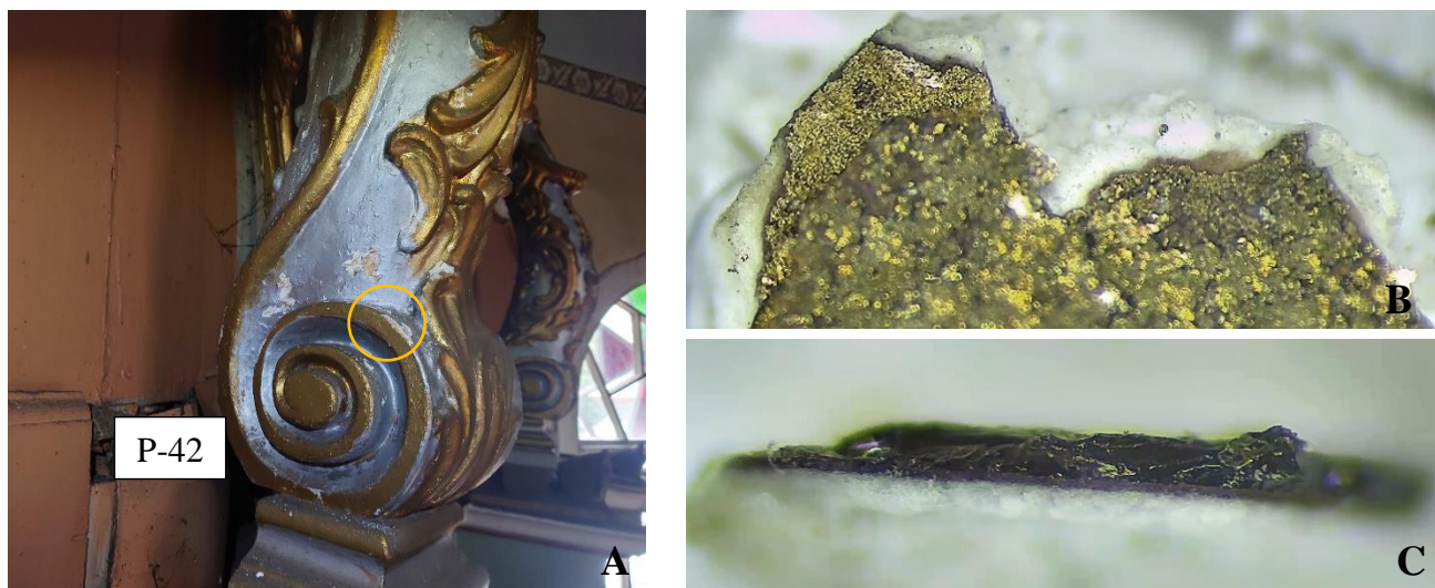
45 pav. Mėginys P-42: A – mėginio paėmimo vieta, B – mėginio vaizdinė pusė pro mikroskopą, x80; C – mėginio skerspjūvio vaizdas pro mikroskopą, x100
