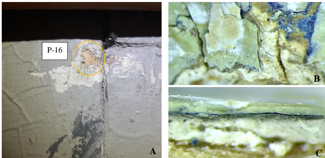
17 pav. Mėginys P-16: A – mėginio paėmimo vieta, B – mėginio vaizdinė pusė pro mikroskopą, x80; C – mėginio skerspjūvio vaizdas pro mikroskopą, x100
