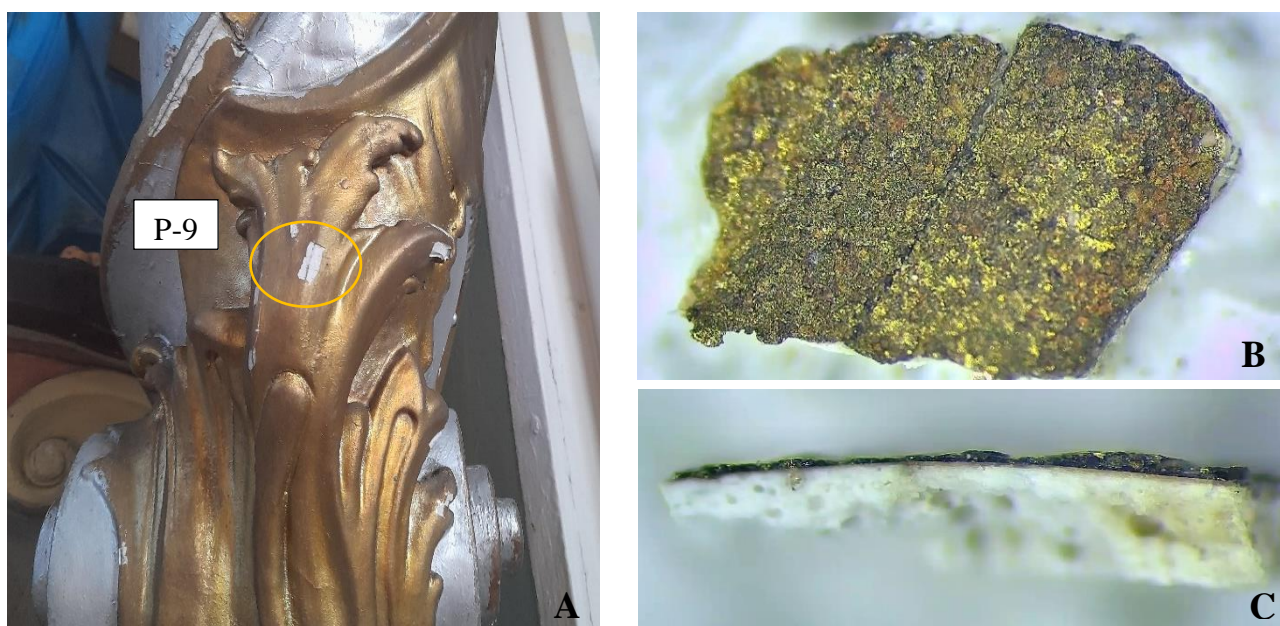
10 pav. Mėginys P-9: A – mėginio paėmimo vieta, B – mėginio vaizdinė pusė pro mikroskopą, x80; C – mėginio skerspjūvio vaizdas pro mikroskopą, x100
