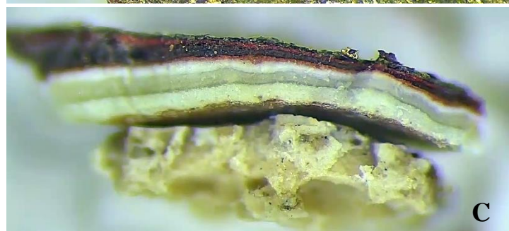
6 pav. Mėginys P-5: A – mėginio paėmimo vieta, B – mėginio vaizdas pro mikroskopą, x80, C – mėginio skerspjūvio vaizdas pro mikroskopą, x100;
