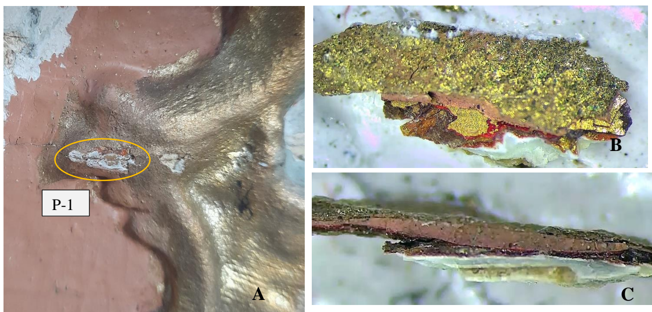
2 pav. Mėginys P-1: A – paėmimo vieta; B – mėginio vaizdas pro mikroskopą, x60, C – mėginio skerspjūvis, x100
