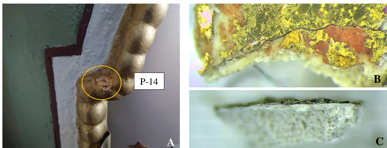
15 pav. Mėginys P-14: A – mėginio paėmimo vieta, B – mėginio vaizdinė pusė pro mikroskopą, x80; C – mėginio skerspjūvio vaizdas pro mikroskopą, x100
