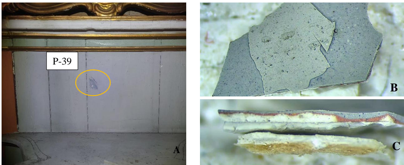
42 pav. Mėginys P-39: A – mėginio paėmimo vieta, B – mėginio vaizdinė pusė pro mikroskopą, x80; C – mėginio skerspjūvio vaizdas pro mikroskopą, x100
