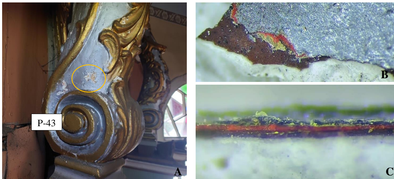
46 pav. Mėginys P-43: A – mėginio paėmimo vieta; B – mėginio vaizdinė pusė pro mikroskopą, x80; C – mėginio skerspjūvio vaizdas pro mikroskopą, x100
