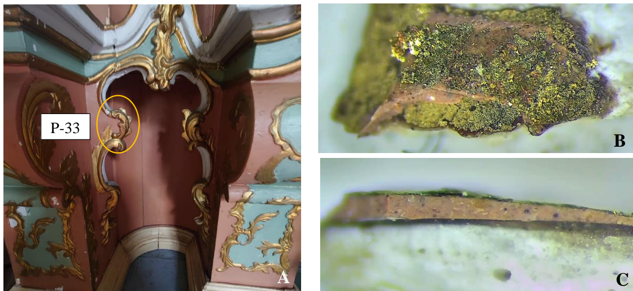
35 pav. Mėginys P-33: A – mėginio paėmimo vieta, B – mėginio vaizdinė pusė pro mikroskopą, x80; C – mėginio skerspjūvio vaizdas pro mikroskopą, x100
