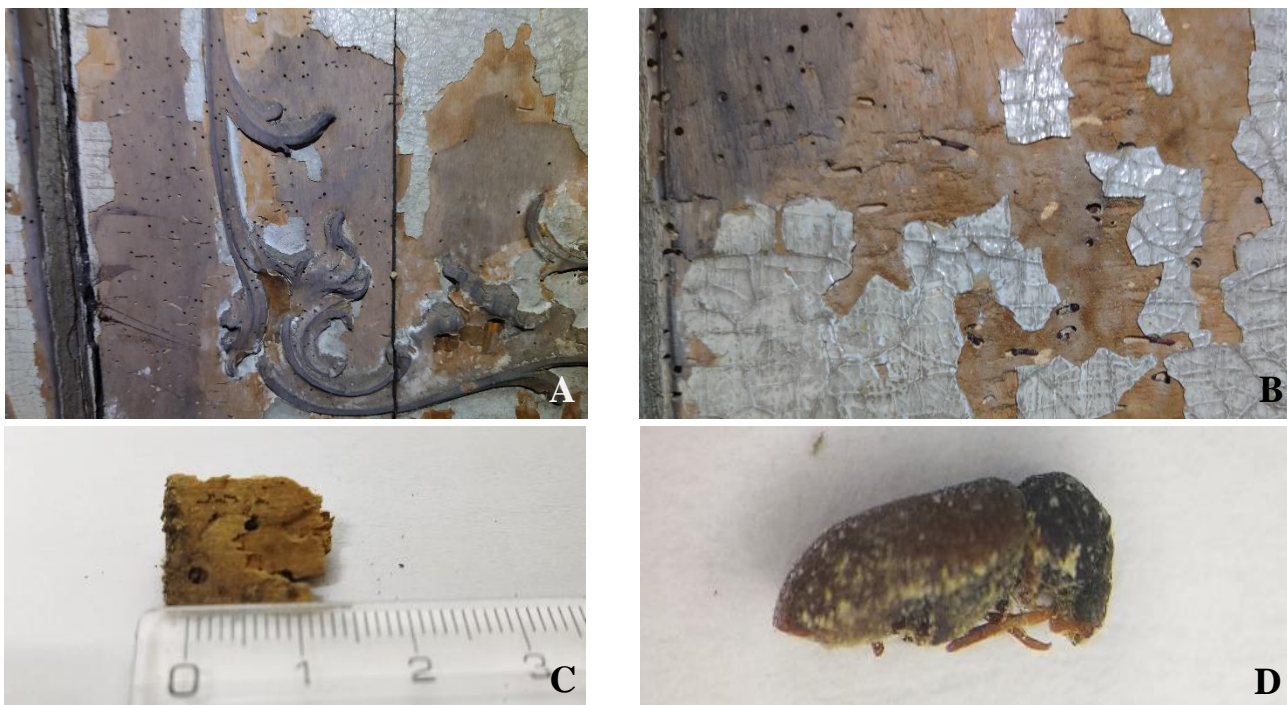
52 pav. A, B – altorių komplekso nugarinėje pusėje matomos entomologinių kenkėjų pažeidimai ir vabzdžiai; C – vabzdžių išlėkimo angos matmenys; D – vabzdžio vaizdas pro mikroskopą, x 40.
