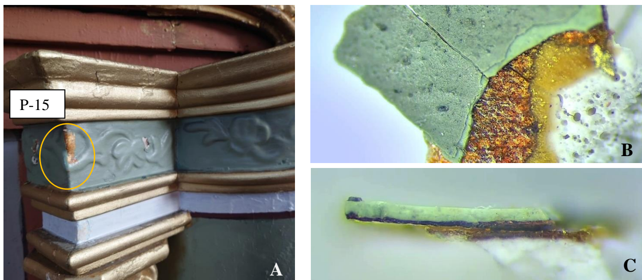
16 pav. Mėginys P-15: A – mėginio paėmimo vieta, B – mėginio vaizdinė pusė pro mikroskopą, x80; C – mėginio skerspjūvio vaizdas pro mikroskopą, x100
