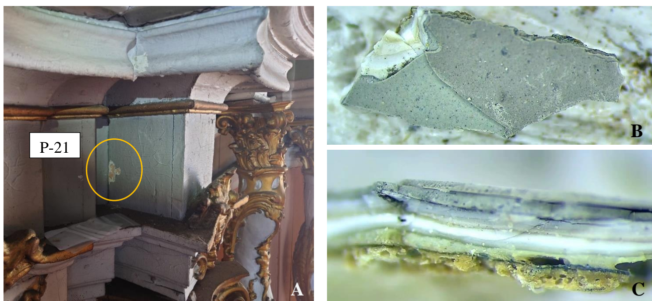
22 pav. Mėginys P-21: A – mėginio paėmimo vieta, B – mėginio vaizdinė pusė pro mikroskopą, x80; C – mėginio skerspjūvio vaizdas pro mikroskopą, x100
