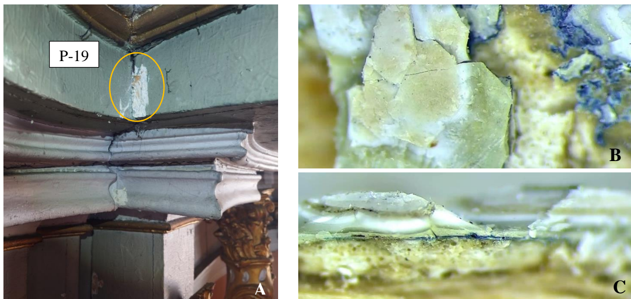
20 pav. Mėginys P-19: A – mėginio paėmimo vieta, B – mėginio vaizdinė pusė pro mikroskopą, x80; C – mėginio skerspjūvio vaizdas pro mikroskopą, x100
